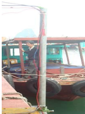
Hình 3.9. Các cần đo sâu sau khi hoàn thành công tác lắp đặt
