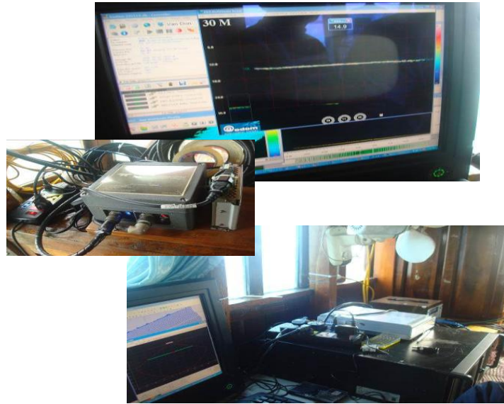
Hình 3.10. Hệ thống máy đo sâu hồi âm đa tia R2Sonic
